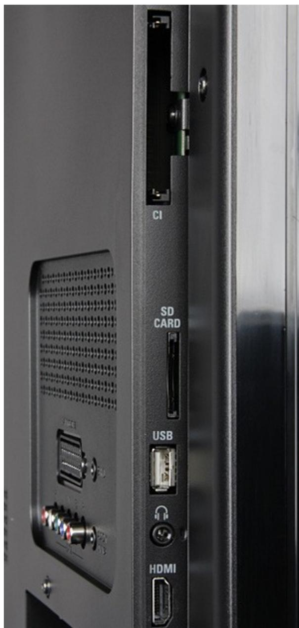
Телевизор оснащен стандартными полноразмерными разъемами. В одном HDMI есть обратный аудиоканал. Поддерживается управление подключенными по HDMI устройствами (HDMI-CEC), в том числе и с помощью меню из пиктограмм,
