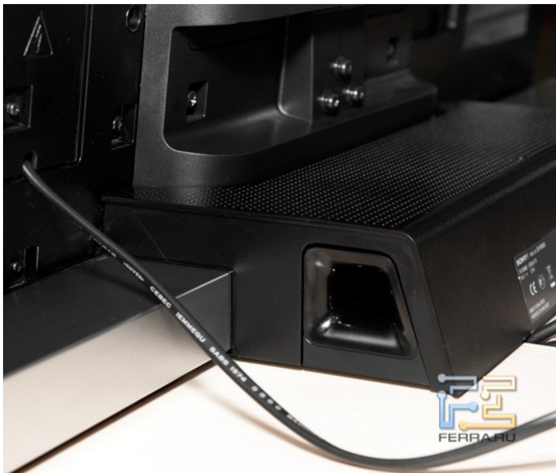
Фазоинвертер сабвуфера на задней стороне SU-B400S
